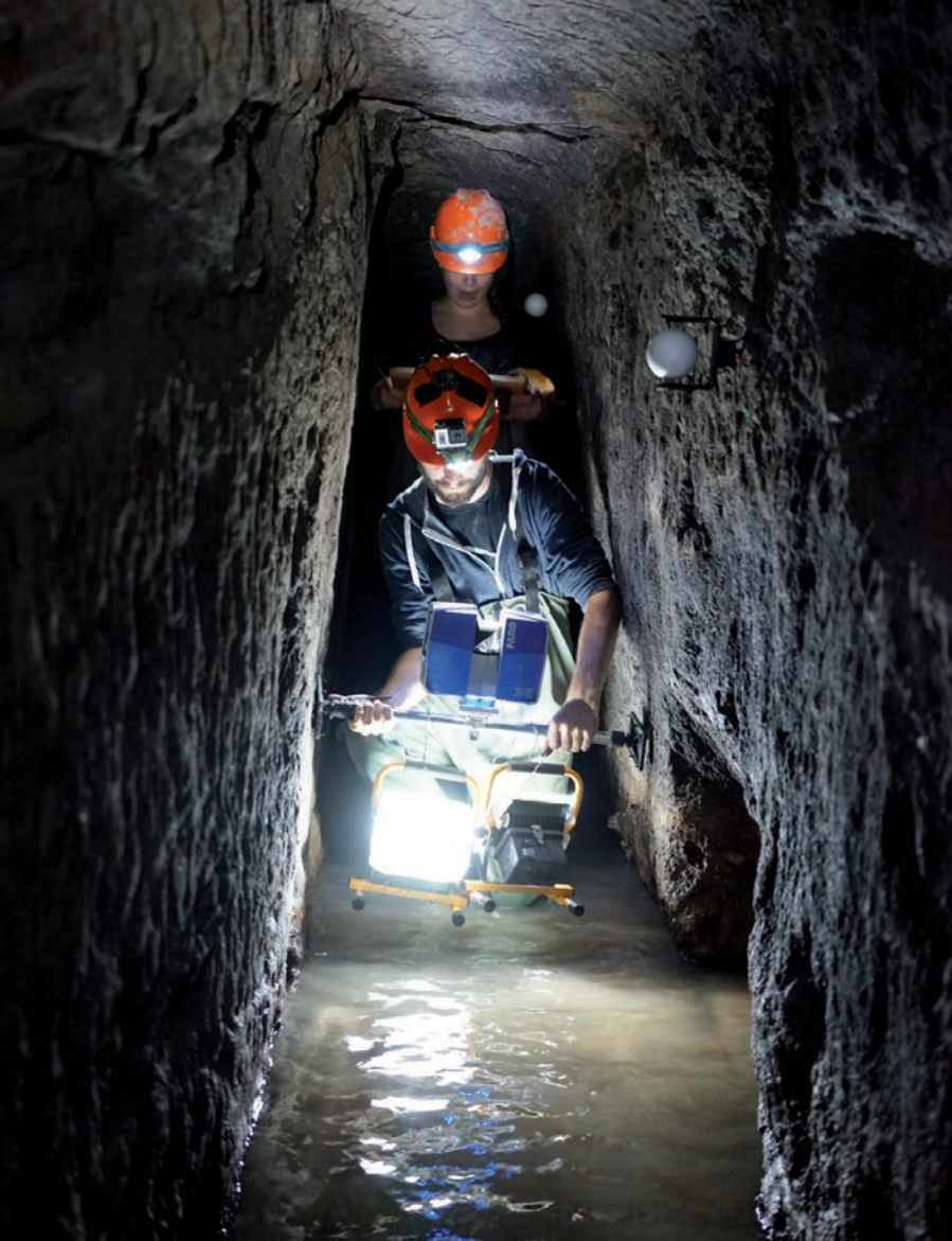
Fig. 11: Oben: Installation des Scanners auf der Spezialanfertigung zusammen mit den benötigten Scheinwerfern. Gut zu erkennen der Passpunkt an der rechten Stollenwand.
