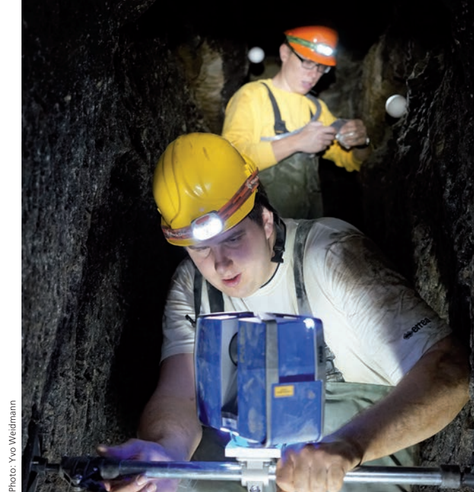
Fig. 8: Fortlaufende Montage des Scanners (mit spezieller Halterung für den Gebrauch in schmalen Stollen) und der Verknüpfungspunkte.
