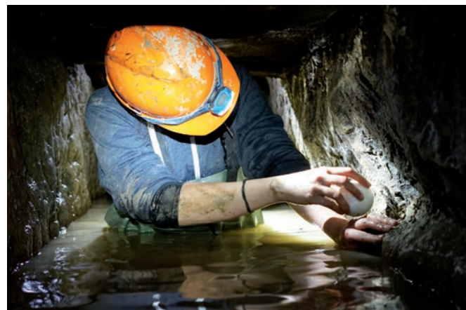
Fig. 12: Montage der Verknüpfungspunkte. Diese durften zwischen den Scans nicht mehr bewegt werden!
