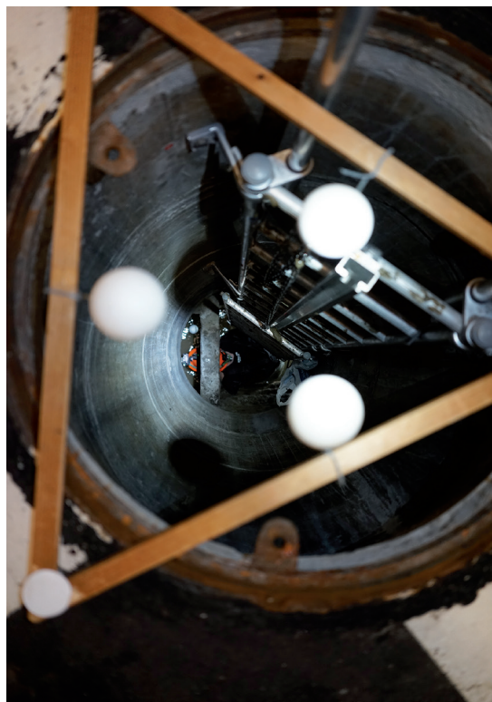
Fig. 7: Verknüpfung der Vermessung der Stollenanlage mit der Oberfläche durch Vertikalschächte. Die drei Verknüpfungspunkte am Schachtkopf garantieren eine zuverlässige Verknüpfung der unter- und oberirdischen Vermessung.
