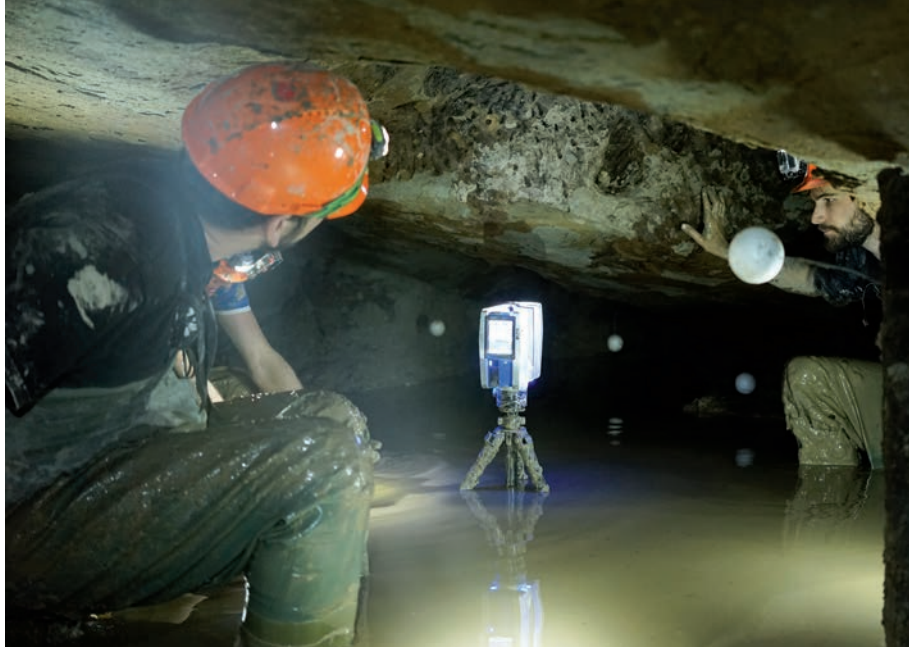
Fig. 2: Scanner, Scheinwerfer und Verknüpfungspunkte im gefluteten Abschnitt der Stollenanlage.
